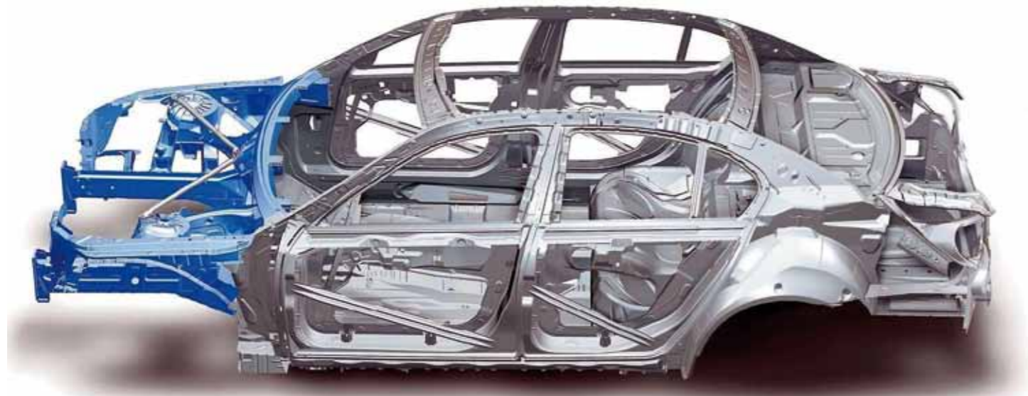
En el BMW Serie 5 2003, la parte trasera de la carrocería y el habitáculo son de acero y la sección anterior es de aluminio, logrando un óptimo reparto de pesos (50/50) entre ejes.
