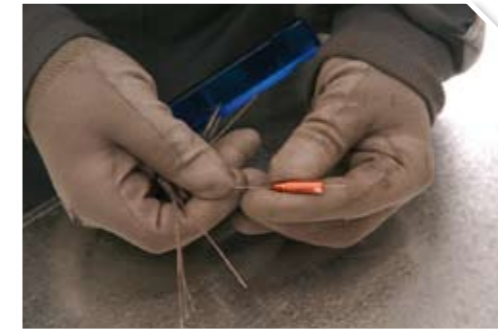
3 Revisar y limpiar la punta de contacto con escuriadores calibrados.
