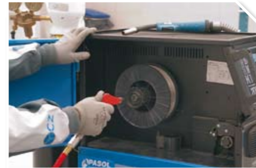
1 Realizar soplado del polvo en el interior del equipo.
