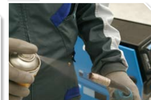
8 Aplicar spray en toberas para evitar adherencia de proyecciones.
