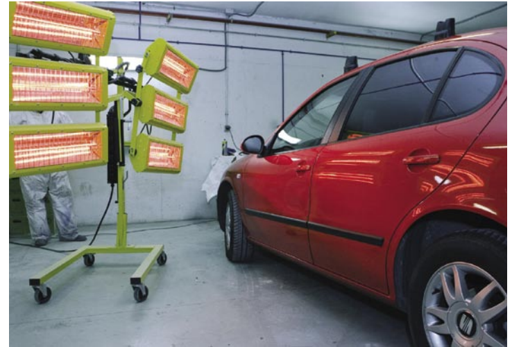
Los profesionales de Auto-Center utilizan los infrarrojos para acelerar el proceso de secado.
