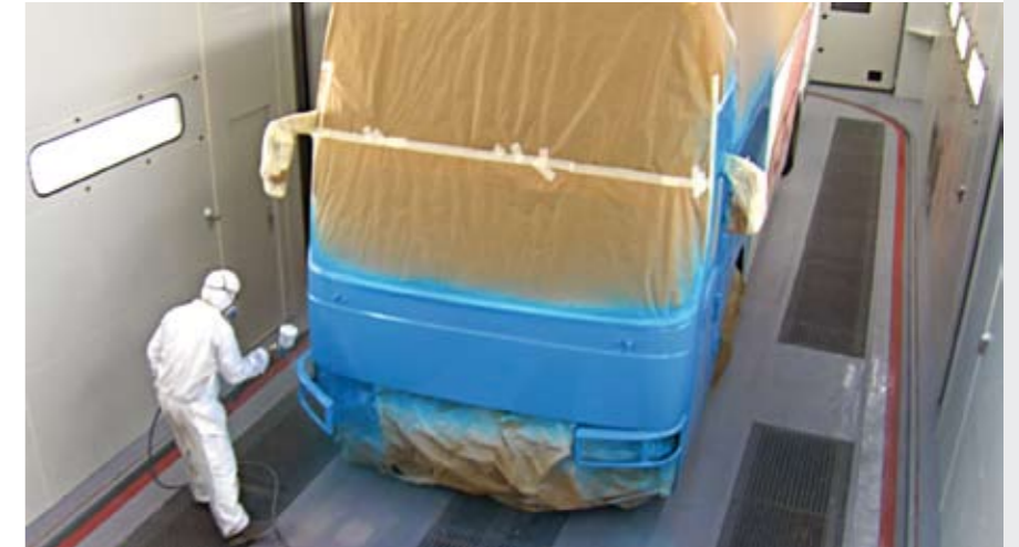
Repintado de un autobús en el interior de una cabina.
