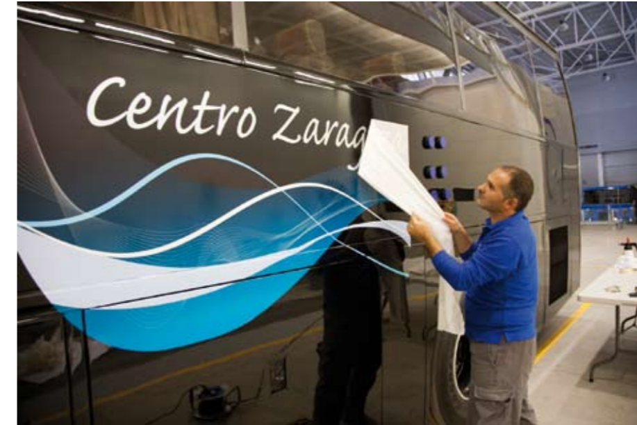
Colocación de vinilo en el lateral de un autocar.
