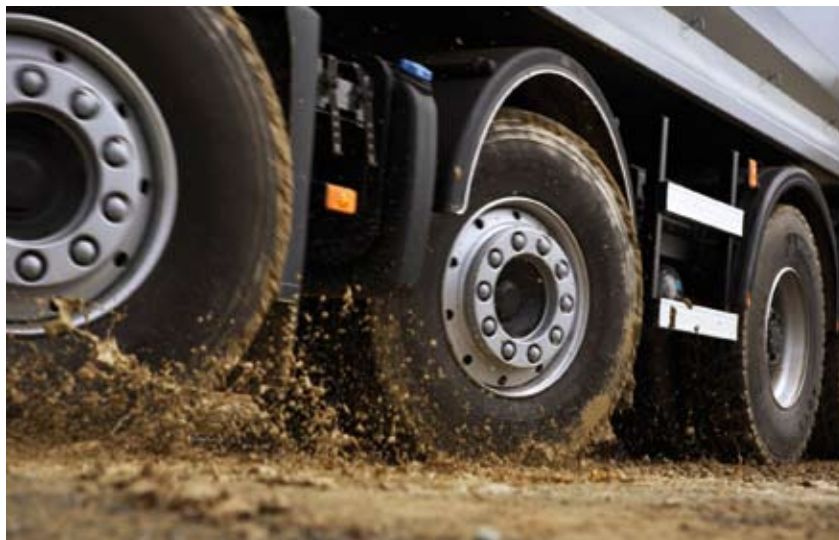
La convergencia de neumáticos fuera de cotas provoca desgastes irregulares y prematuros.
