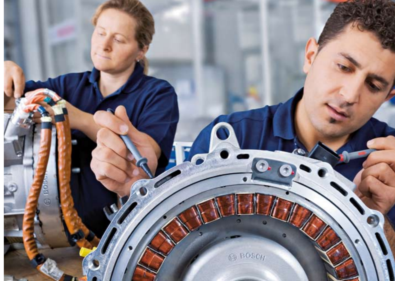
El motor eléctrico, un disco de 30 centímetros de diámetro, se sitúa entre el motor de combustión y el mecanismo de transmisión.
