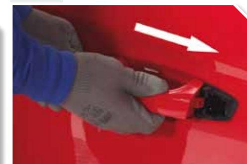
8 Desplazar ligeramente hacia atrás la maneta para liberar la parte posterior.
