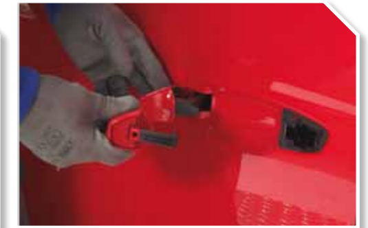
9 Girar la maneta para extraerla completamente.
