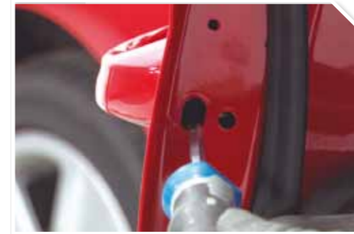
4 Desenroscar hasta el tope el tornillo prisionero (exterior).
