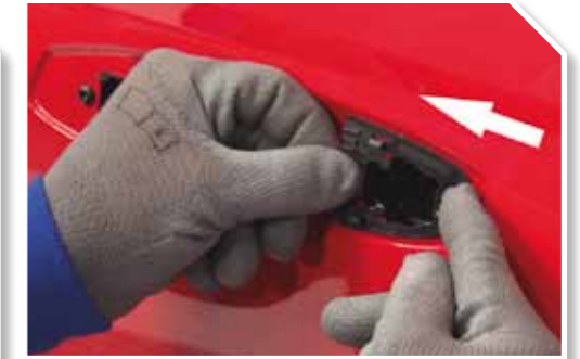
10 Retirar la base de goma de asiento de la maneta, desplazándola hacia delante.
