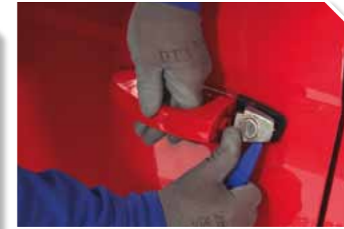
7 Tirar ligeramente de la maneta y sacar el bombín con una palanca de teflón.
