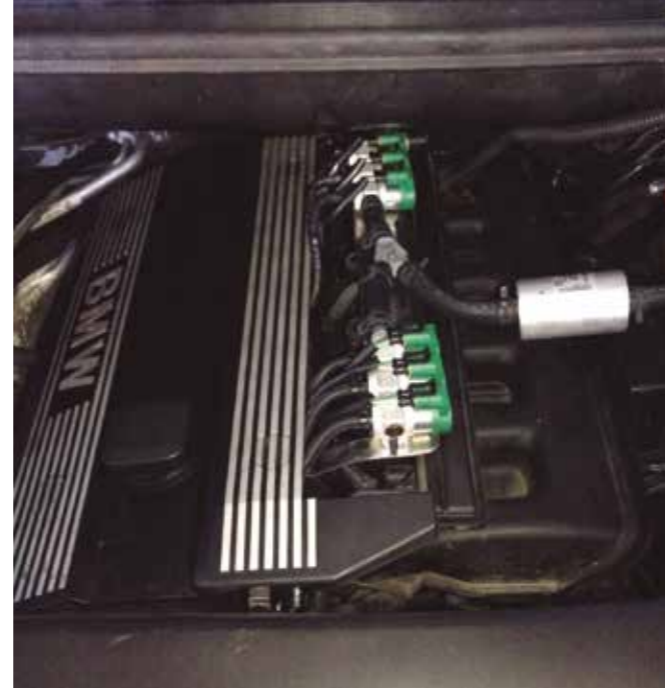
En las transformaciones hay que prestar atención en la colocación de tuberías, depósito e inyectores.
