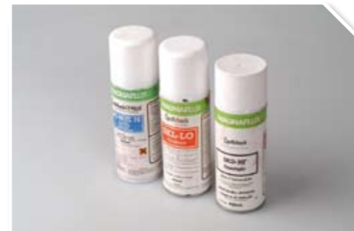
1 Preparar los líquidos penetrantes
