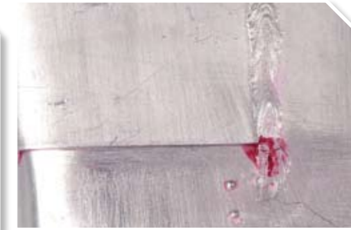
9 Si aparece el revelador, significa que hay presencia de fisuras
