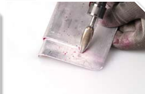
10 Si hay fisuras, reparar las mismas y repetir el proceso de comprobación
