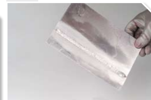
8 Si no aparece el revelador, indica que no hay fisuras externas
