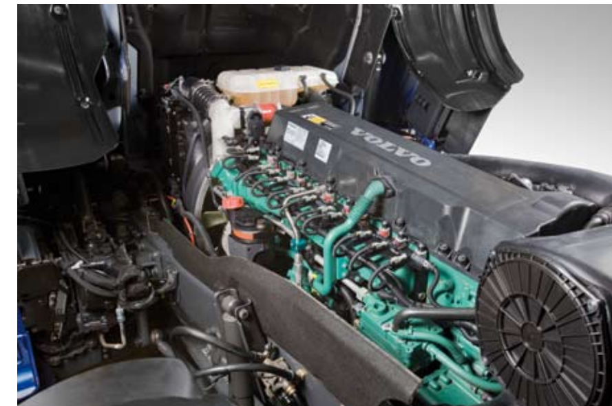
Motor DC 13 gas del modelo Volvo FM Metano-Diésel.
