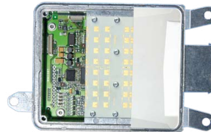
El sensor de radar de 24 GHz tiene un alcance de 60 metros para detectar otros vehículos.
