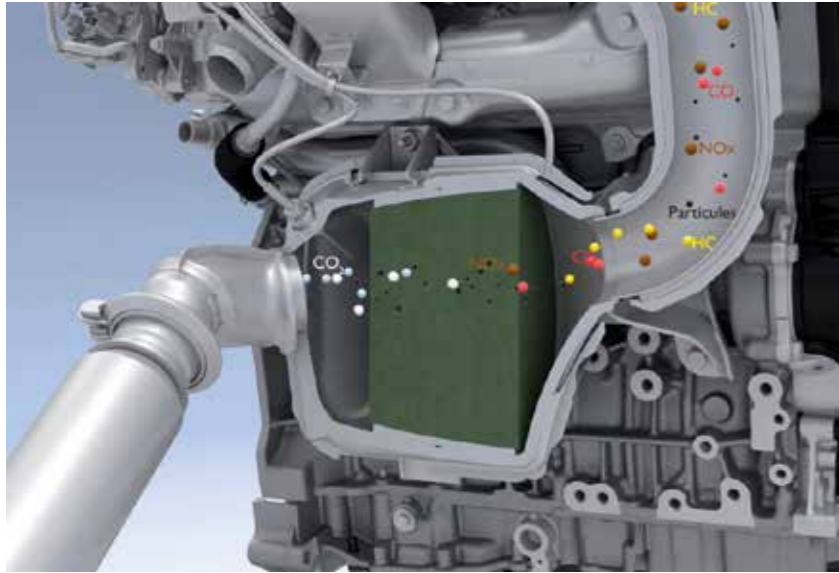
Los FAP reducen las emisiones nocivas de los gases tóxicos con una eficacia superior al 95%.
