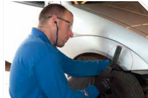
4 Eliminar tensiones de la chapa en la zona y alinear aristas y líneas
