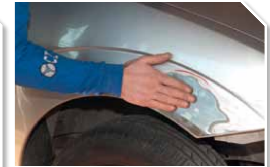
9 Verificar de nuevo el estado de la superficie. Si es correcto, dar por finalizado el reconformado
