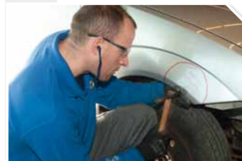
5 Reconformar mediante golpeteo de la superficie con herramientas adecuadas al daño (tas, martillo, lima, palancas o tranchas)
