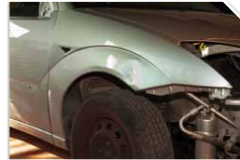
3 Realizar los desmontajes necesarios para disponer de acceso a la zona a trabajar
