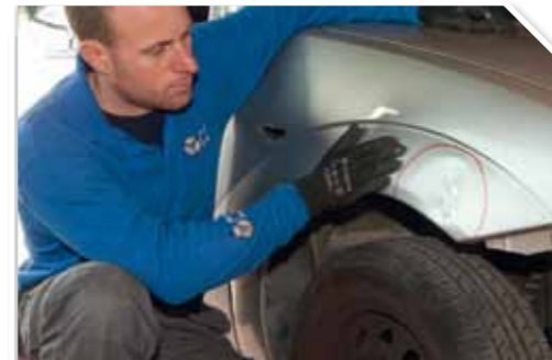
1 Identificar y delimitar el daño
