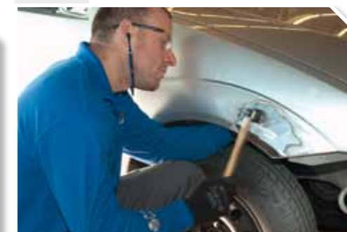
8 Afinar la forma de la superficie con la lima de repasar y tas
