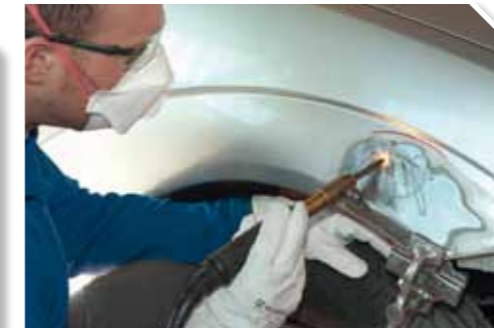
7 Si la chapa se estira, recoger con tratamientos térmicos como el electrodo de grafito
