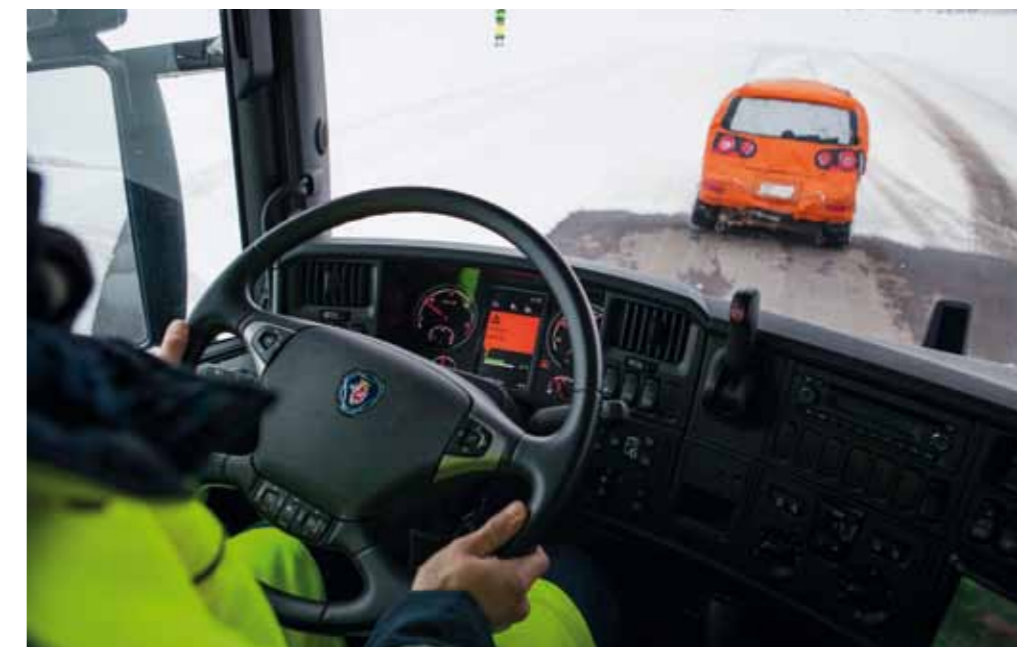
Los sistemas de frenado de emergencia (AEB) combinan un radar de medio/largo alcance con una cámara situada tras el parabrisas.
