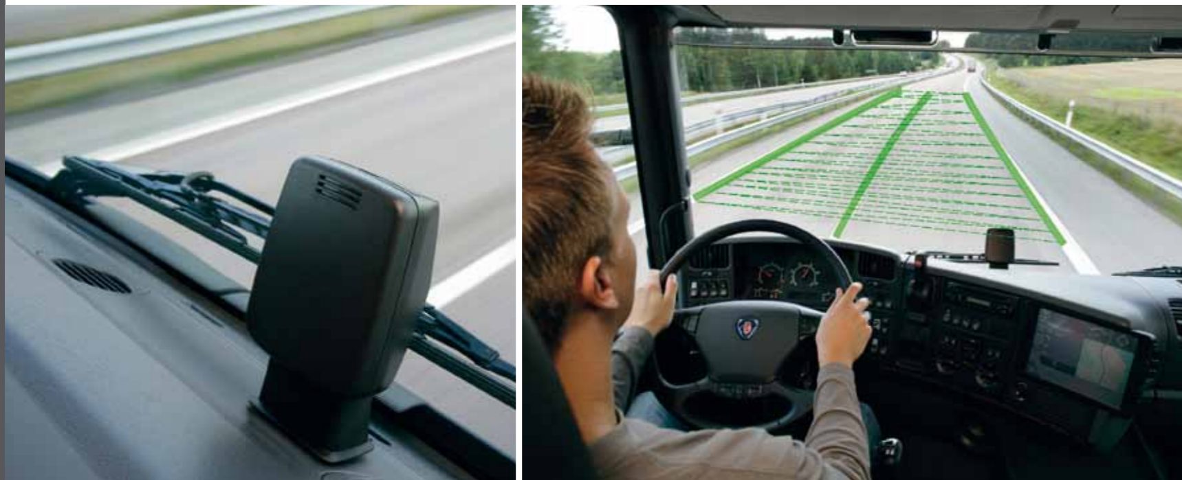
Mediante una cámara, el sistema LDW monitoriza el carril.
