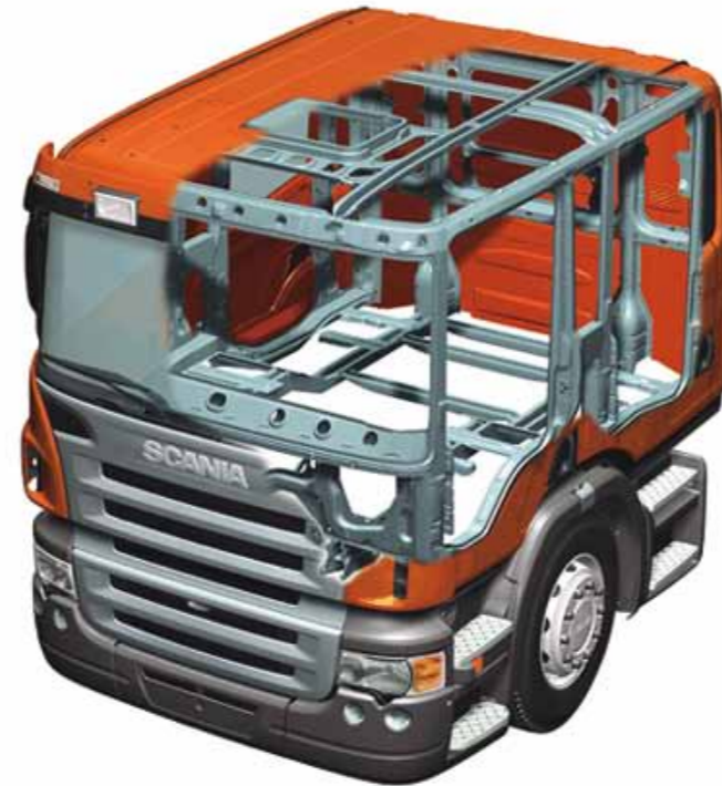
En las cabinas de camiones, donde la propia estructura absorbe el impacto, el armazón debe ser de acero resistente y flexible al mismo tiempo.
