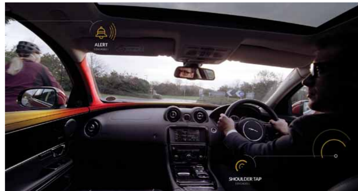
Bike Sense alerta al conductor de la presencia de ciclistas o motocicletas alrededor del vehículo.
