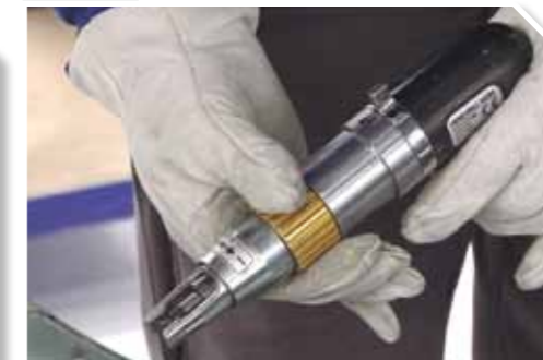
7 Ajustar la profundidad de despunteado
