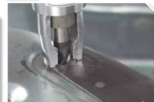
8 Realizar el despunteado del punto
