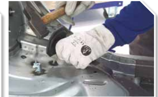
9 Comprobar que el punto está correctamente taladrado
