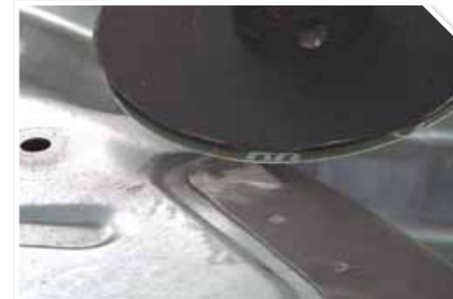
4 Eliminar bordes de los puntos de soldadura y rectificar la superficie
