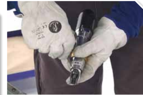
6 Efectuar el montaje de la fresa
