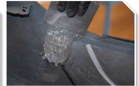
10 Aplicar adhesivo para el acabado final
