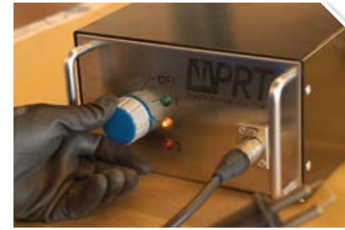
3 Conectar el equipo y seleccionar la temperatura de calentamiento según espesor y tipo de plástico
