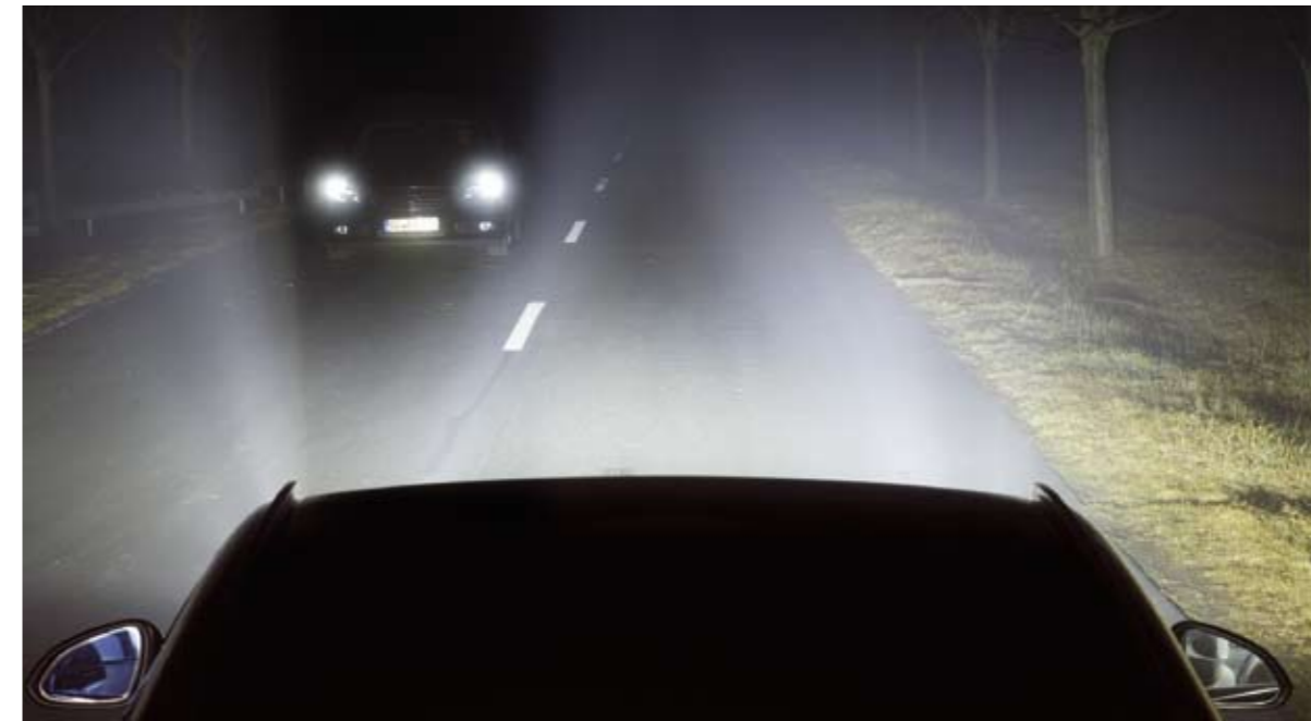
Con Led Matrix, las luces largas se mantienen conectadas sin deslumbrar y se ajustan a la situación del tráfico.
