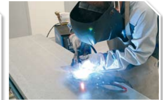
10 Realizar soldadura en probetas para comprobar parámetros.
