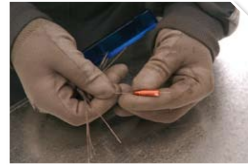
3 Revisar y limpiar la punta de contacto con escariadores calibrados.
