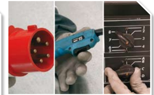
9 Comprobar el estado de enchufe, potenciómetros e interruptor.
