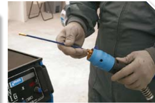
7 Verificar estado de la manguera y limpieza del tubo guía de alambre.
