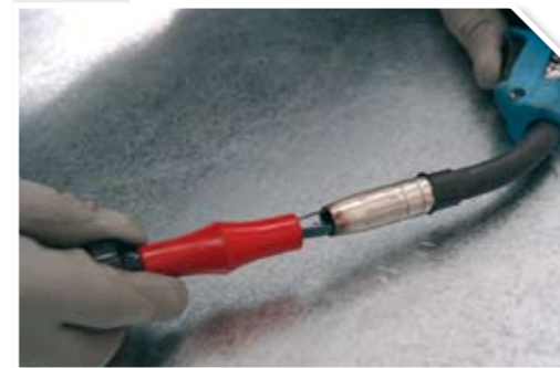
2 Revisar tobera de gas y eliminar proyecciones.
