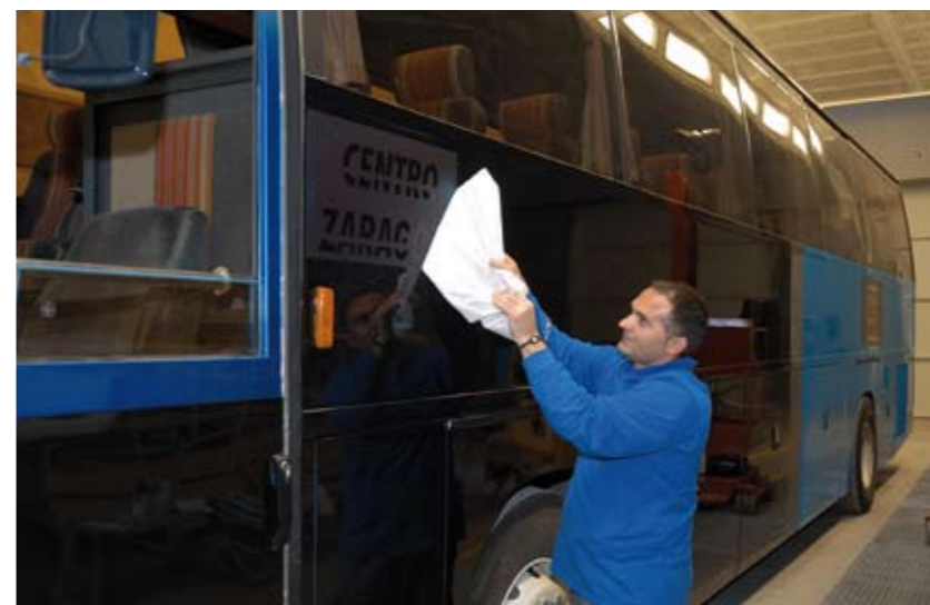
Colocación de una máscara sobre la superficie del V.I. en una operación de rotulación.
