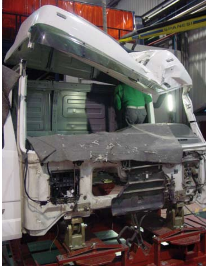
Daños estructurales en la cabina de un camión.
