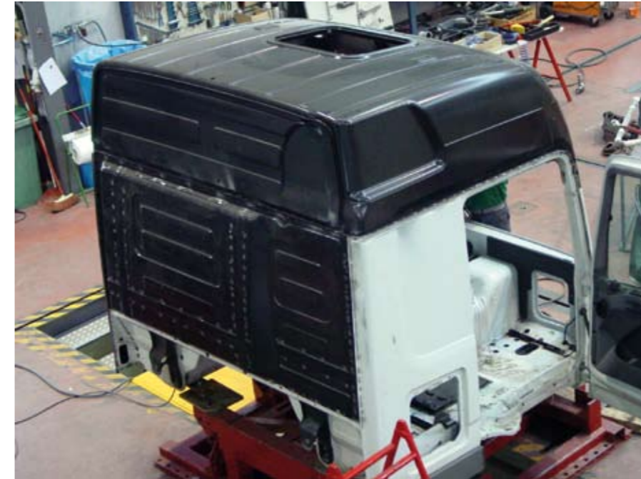
Cabina reparada y elementos sustituidos.
