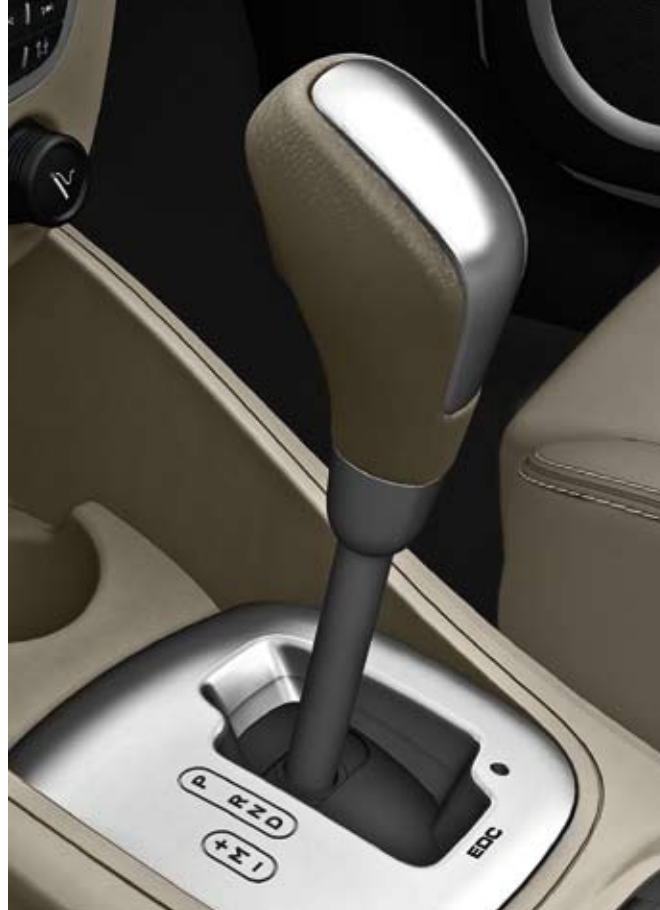
El mando de velocidades es de tipo automático (PRND) con modo impulsional (+/-).
