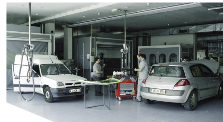
La superficie mínima del área de carrocería rápida de Renault, con cabina incluida, es de 145 m 2 .
