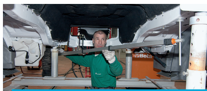
Control dimensional de los largueros en el piso de la cabina.
