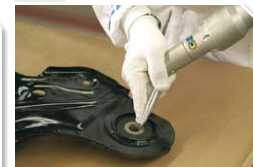
7 Medir la pieza que no esté dañada.
