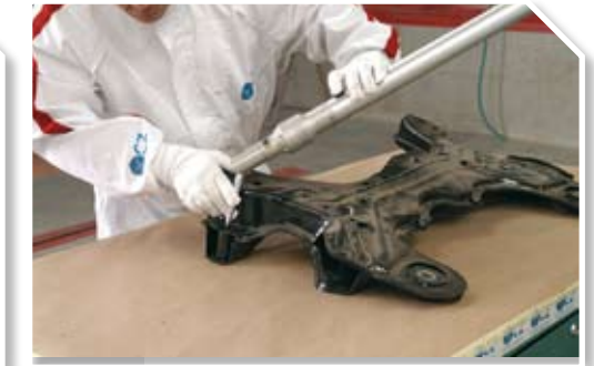
9 Medir la pieza dañada.
