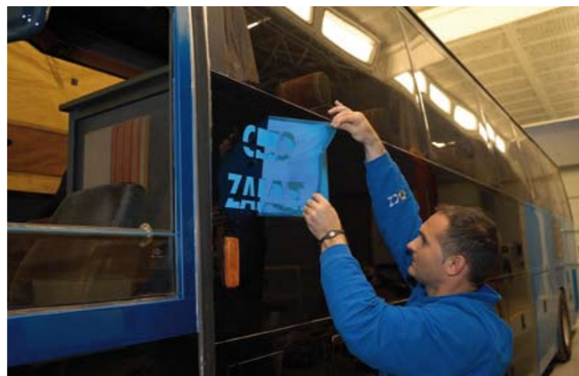
Un operario descubriendo la rotulación.
