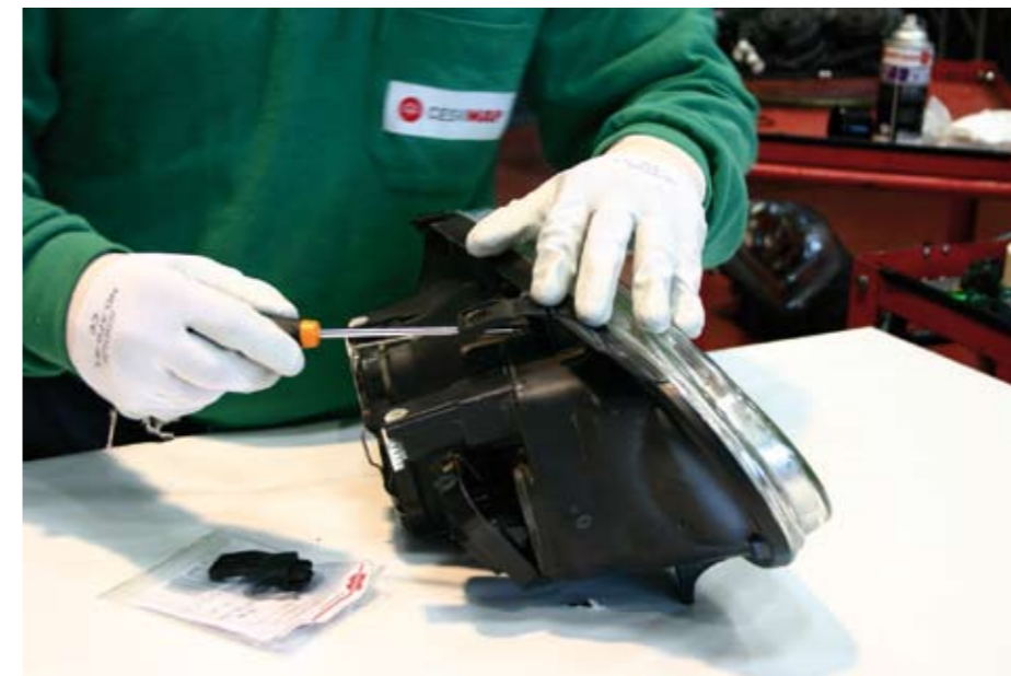
Las patillas rotas de un faro pueden recuperarse utilizando un juego específico de reparación.
