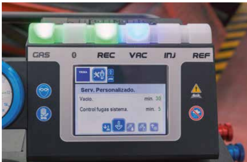
El vacío se realiza en 30 minutos; el control de fugas, en 5.
