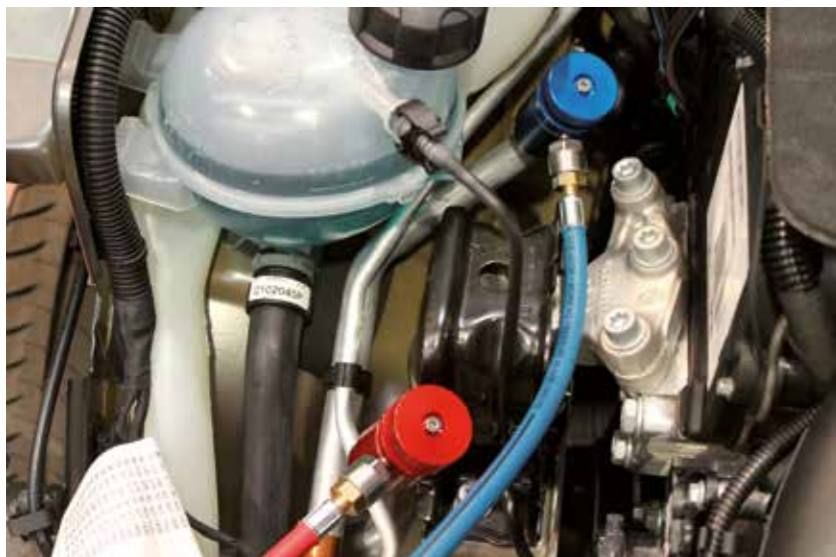
Conexión de las válvulas de servicio al vehículo.
