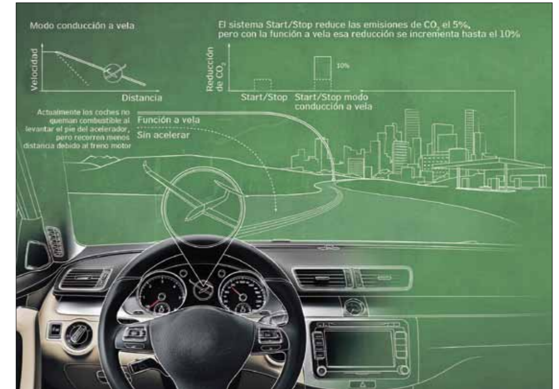
Esquema del modo de conducción a vela diseñado por Bosch.
