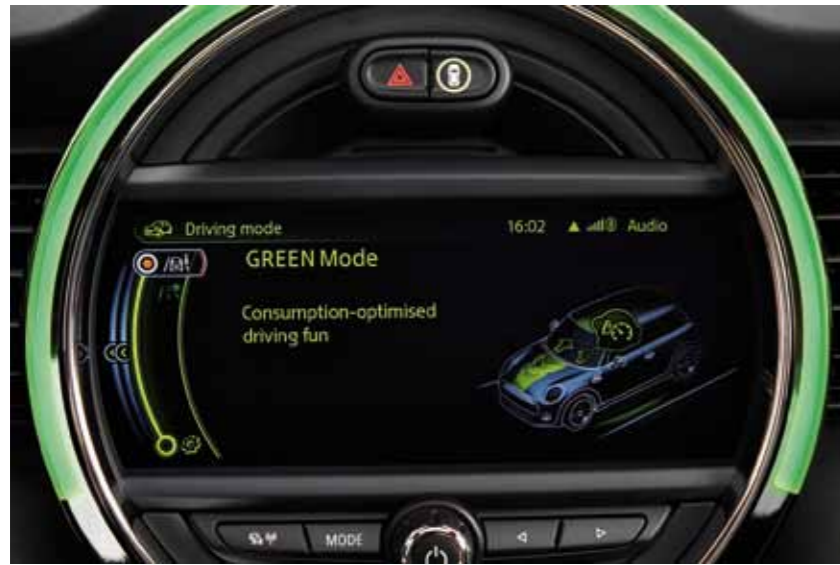
En el modo Green de Mini, al soltar el acelerador, la transmisión se desacopla del propulsor.
