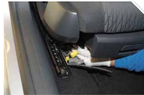
2 Desacoplar los conectores.
