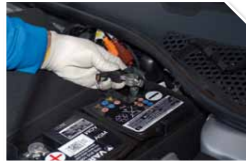
1 Preparar la herramienta y desconectar la batería.
