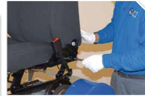
6 Desmontar el respaldo.
