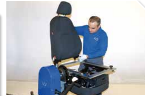
7 Colocar el respaldo en el soporte.
