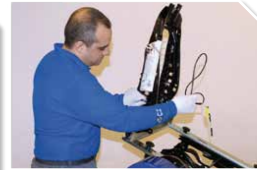
9 Separar el mazo de cables.
