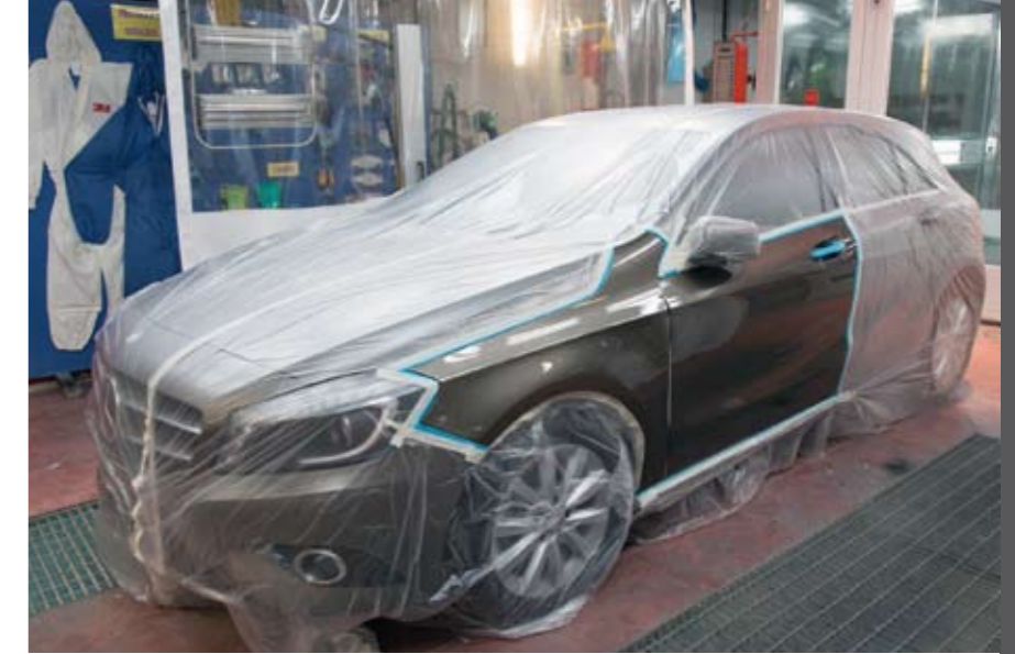
Fundas de enmascarado, adecuadas para tapar vehículos completos de cualquier longitud.
