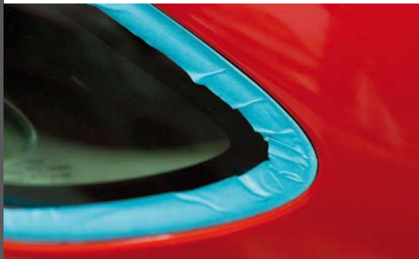
Diferencias entre enmascarar zonas sensibles de forma correcta (izquierda) e incorrecta (derecha).
