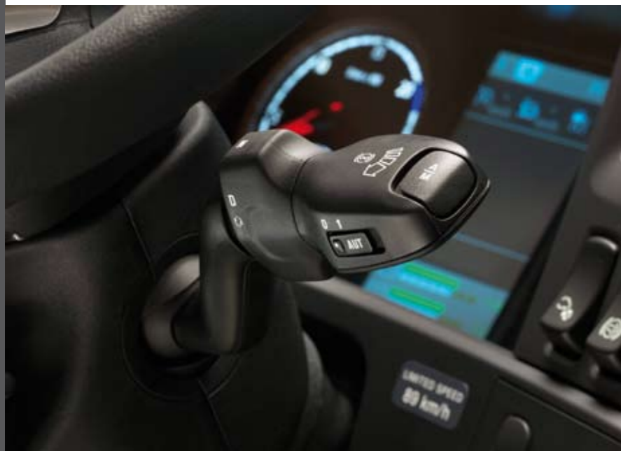
Palanca para accionar modos de conducción del sistema Scania Opticruise.
