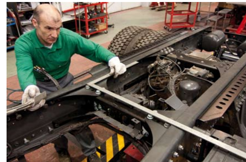
Comprobación de los travesaños con escuadra.
