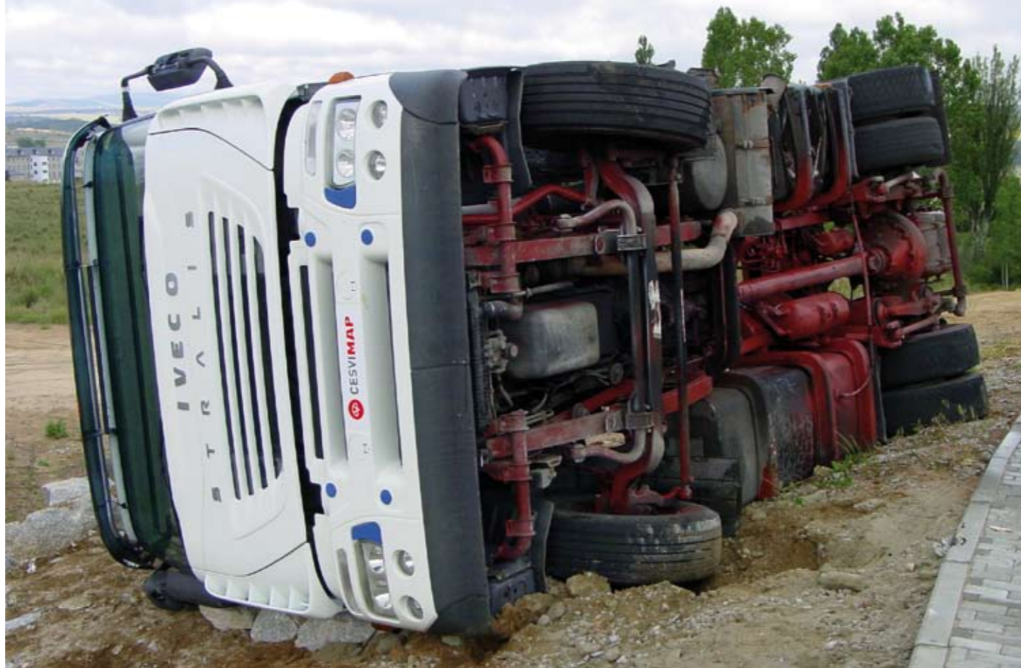
Los daños por torsión se producen en la mayoría de los vuelcos.
