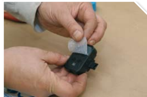
2 Retirar el gel residual del sensor.
