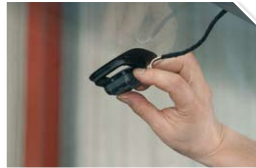
1 Separar el sensor de lluvia y luz del parabrisas.
