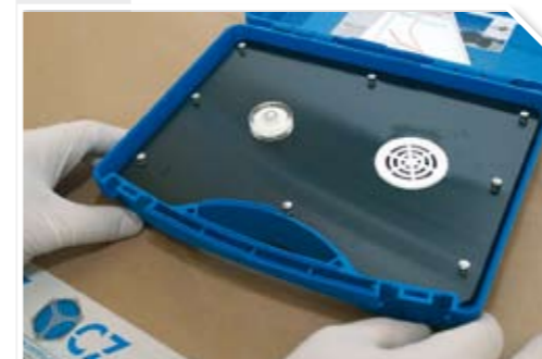
4 Colocar y nivelar el sensor en posición horizontal.
