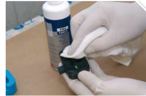
3 Limpiar la superficie del sensor con el limpiador específico y un paño de microfibra.
