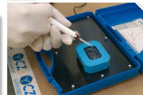
7 Colocar la plantilla sobre el sensor y éste sobre el equipo recuperador.
