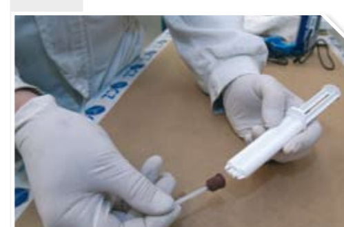
5 Preparar el aplicador (inyector) del gel, colocando la boquilla mezcladora.
