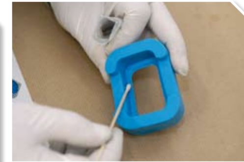
6 Aplicar a la plantilla que sirve como molde una delgada capa de desmoldeante.
