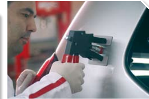
6 Extraer la abolladura (depresión) mediante el útil de tracción.
