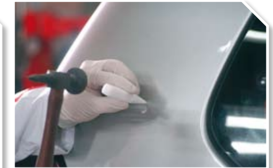
9 Eliminar el pico sobresaliente con el puntero de teflón o poliamida si fuese el caso.
