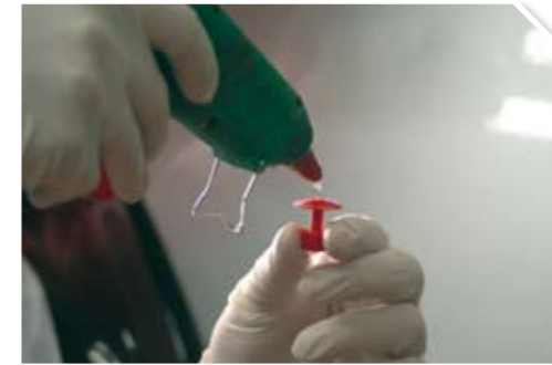
3 Aplicar adhesivo sobre la ventosa o base.
