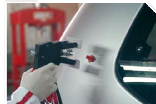
5 Dejar enfriar el adhesivo y acoplar la herramienta de tracción a la ventosa.
