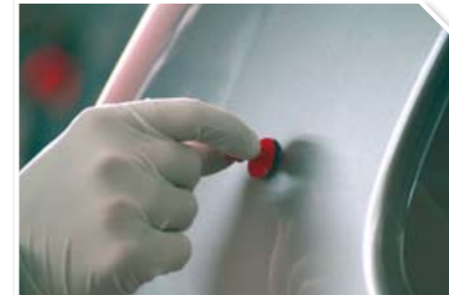
4 Pegar la ventosa en la depresión del daño (en el centro de ella).
