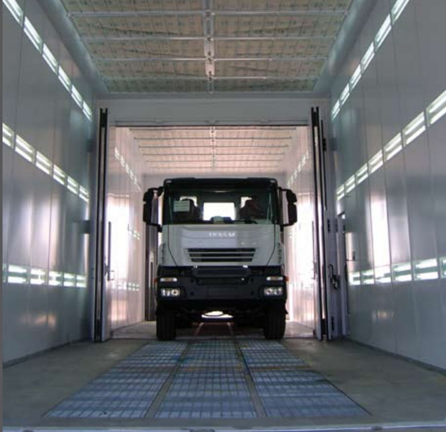
La cabina de pintado está preparada para autobuses, camiones, portavehículos y maquinaria de obras.
